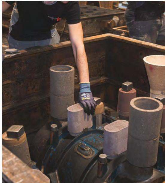
Als Gießereimechaniker/in der Fachrichtung Handformguss stellst Du Gussformen von Hand her und produzierst Gussteile aus Stahl in Kleinserien oder als Einzelstücke. Überall im Leben, ob in PKW, Flugzeugen, Schiffen, Anlagen, Maschinen oder im Haushalt begegnen uns gegossene Metallteile. Mithilfe von Modellen stellst Du von Hand Einmalformen – Sandgussformen – her. Dazu werden Modellteile in Formsand gebettet, verdichtet und die Teile wieder entnommen und zur fertigen Form zusammengesetzt. In
