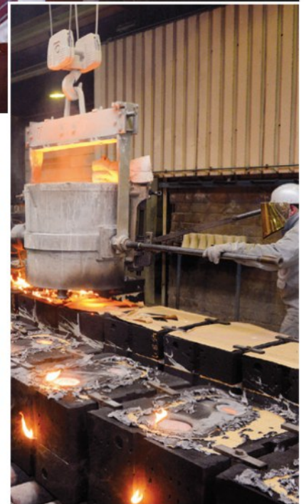
Der Stahl ist 1600 Grad heiß, wenn er gegossen wird.
